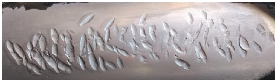
NUMERAÇÃO DO CHASSI APÓS LIMPEZA E TRATAMENTO QUÍMICO METALOGRÁFICO
