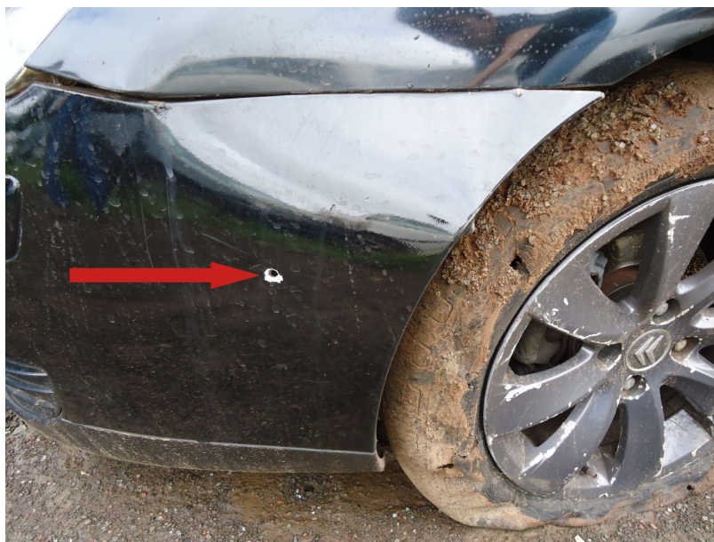
Fotografia nº 05- imagem mostrando a perfuração existente na região lateral esquerda do para-choque dianteiro do veículo e o pneu dianteiro esquerdo esvaziado e avariado.
