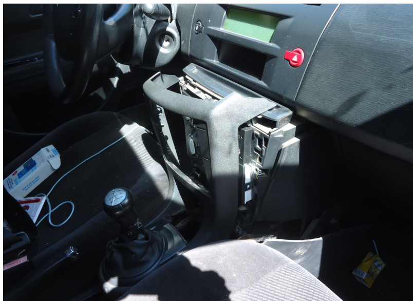
Fotografia nº 04- imagem mostrando os danos na moldura do rádio e do controle do sistema de ventilação do veículo.
